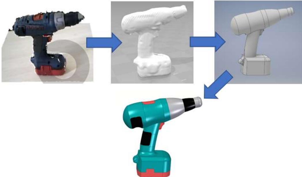
7.h. ábra - Reverse engineering folyamata példán keresztül
