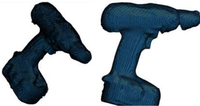
6.1.b ábra - Háromszögesített pontháló
